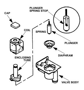
**Dump Valve Disassembly**
