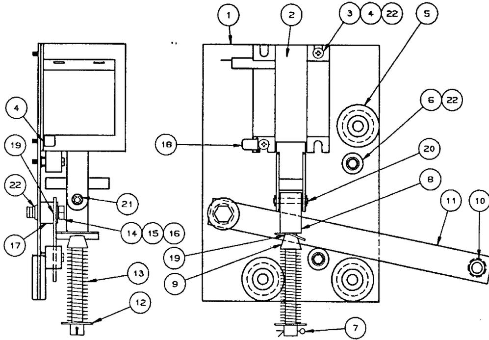
**FIGURE 11. SOLENOID ASSEMBLY - EXPLODED VIEW & PARTS LIST**
